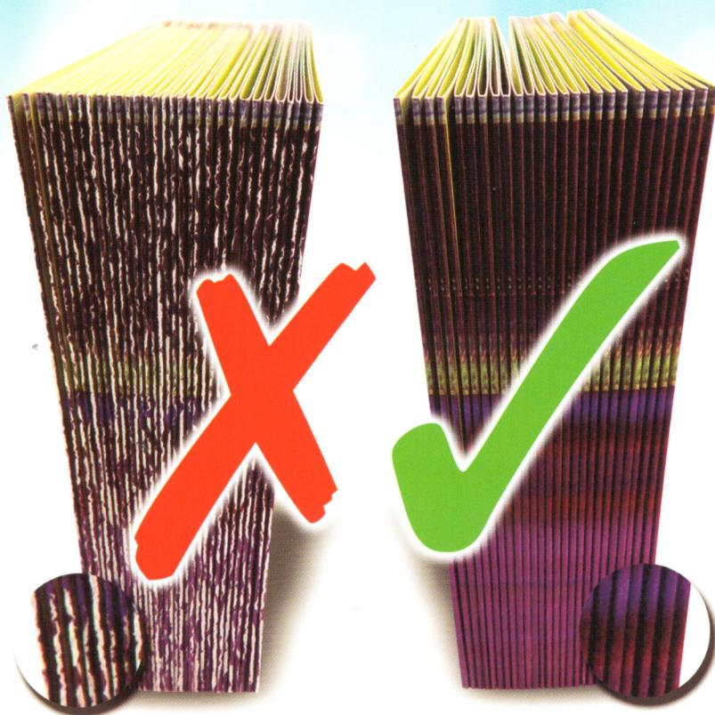
**La rottura delle fibre è un problema vecchio.
