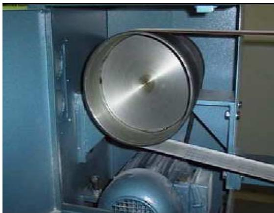
Trasmissione del nastro di smerigliatura
